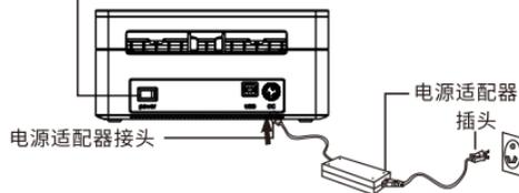
注意:请先关闭打印机,再接上电源线。
